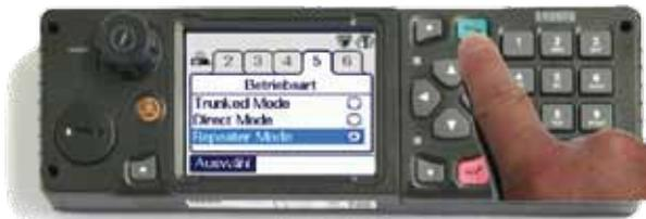
Repeater schaltet Symbol wird sichtbar
