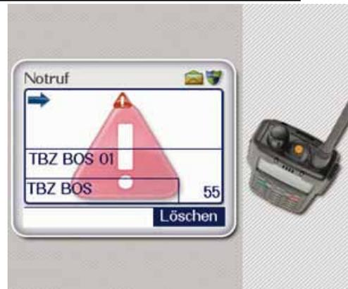
Durch das Drücken der Notruf-Taste, wird der Notruf geschaltet. Laufende Gespräche werden unterbrochen und der Notrufende hat 30 Sekunden Zeit seinen Notruf abzusetzen. Hierbei muss die Notruftaste nicht gedrückt werden.
