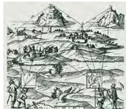
Die dazu gehörenden Messinstrumente werden als **Kippregeln** bezeichnet. Kippregeln sind Instrumente zur simultanen Messung aller drei Komponenten der räumlichen Polarkoordinaten eines Punktes.
